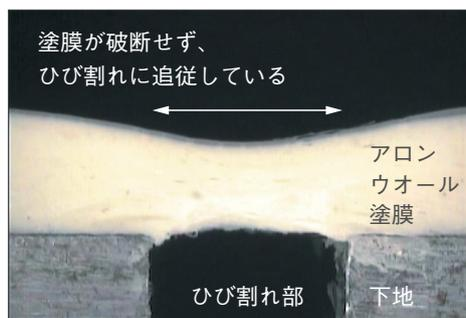
写真1 アロンウオールのひび割れ追従状態
